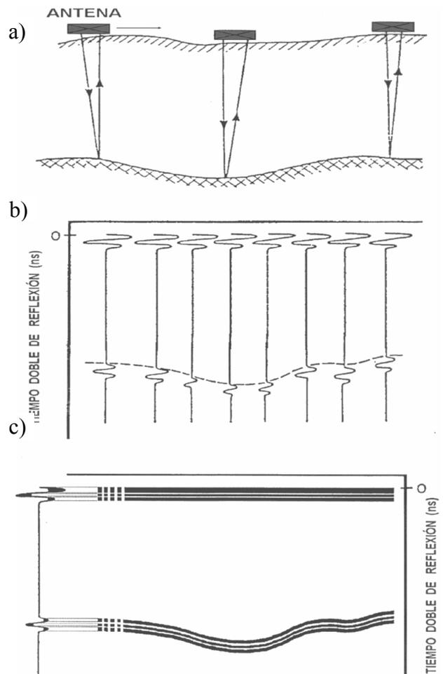
Fig. 2. Proceso de adquisición (a), radargrama en formato *wiggle* (b) y radargrama en formato *line scan* (c).
