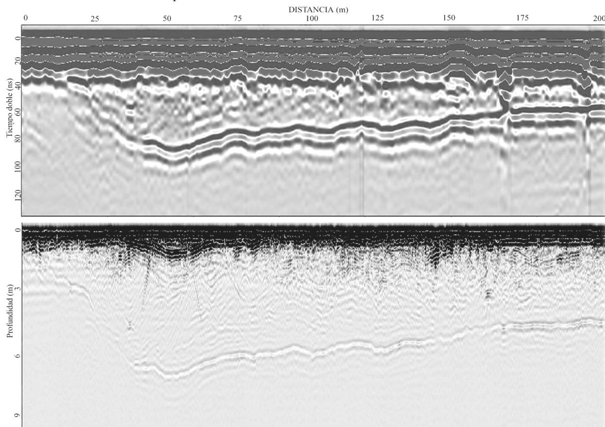
**Fig. 8.** Perfiles de 200 m efectuados con una antena no apantallada de 100 MHz (superior, a) y otra apantallada de 250 MHz (inferior, b) donde se detectan las reflexiones relacionadas con la roca madre. En ambos casos la ventana de tiempos fue fijada en 120 ns, equivalentes a unos 9 m de profundidad.
