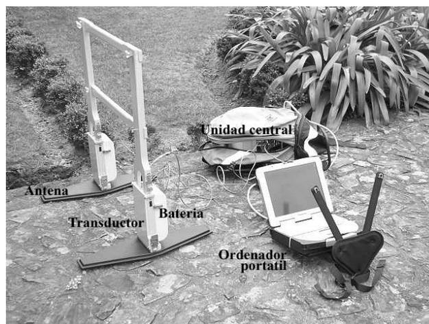
Fig. 3. Componentes habituales en un sistema de geo-radar, donde se muestra un par de antenas no apantalladas de 200 MHz.
