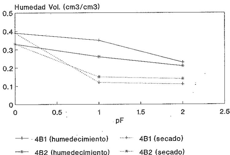
Figura 3. Distinta evolución de dos muestras de suelo en las fases de humedecimiento y desecación (histéresis), medida mediante la utilización conjunta del sistema TDR y tensiómetros.
