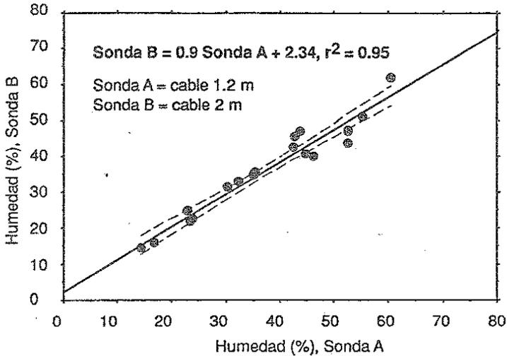
Figura 1. Correlación entre la medida de humedad realizada con sondas TDR de longitud diferente (Sistema TDR, Imko).
