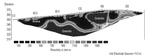
Fig. 5. Pseudosección de resistividades aparentes obtenida sobre los niveles de alteración de la granodiorita del plutón de Alforja. En el perfil se refleja claramente la irregularidad del relieve del basamento, con la presencia de bolos de elevada resistividad.
