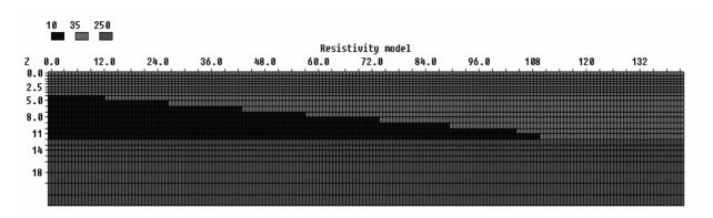
Fig. 2. Modelo sintético simulando un acuífero situado a 12 metros de profundidad, cubierto por una zona no saturada constituida por un nivel de arcillas que se acuña bajo otro nivel superior arenoso.
