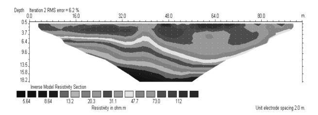
Fig. 6. Pseudosección de resistividades aparentes obtenida sobre la terraza aluvial del valle bajo del río Llobregat. La ausencia de niveles conductores en la zona no saturada implica el elevado riesgo de contaminación por vertidos contaminantes en este contexto. En cambio, la geometría del sustrato impermeable constituido por las arcillas rojas de Burdigaliense destaca claramente en la parte inferior de la sección.
